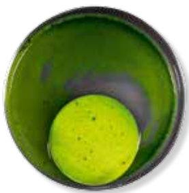
Kein Filmschutz: Algen und Pilze befallen die Fassade
